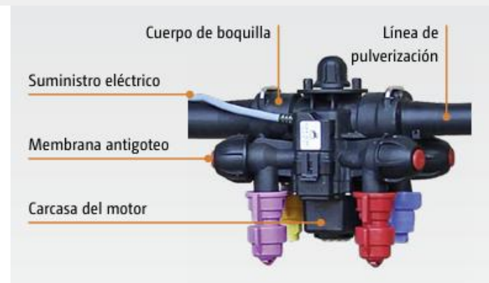
AmaSwitch con cuerpo de boquilla cuádruple y juego de prolongación para una distancia real de boquillas de 25 cm
